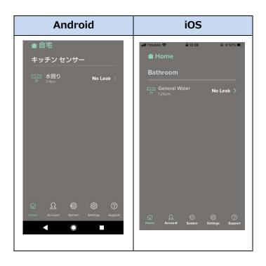
水漏れが検知された場合、アラートが発生し、通知をクリックすると下記画面に遷移します。 この場合、水漏れが発生した可能性がありますのでセンサー設置場所を確認し、 水漏れを検知した旨を水漏れチェッカーサービスデスクへご連絡ください。 水漏れチェッカーサービスデスクの電話番号はマイページに表示されております。
