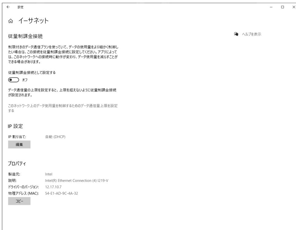
5. IP設定の「編集」を選択し、IP設定の編集画面が表示されます。「自動(DHCP)」が選択されていることをご確認ください。
