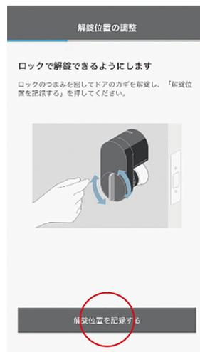
**7** 解錠位置の調整画面に従ってドアを解錠し、「解錠状態を記録する」をタップします。
