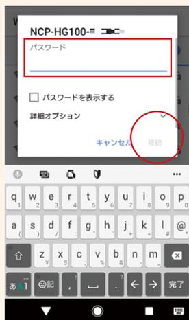
5 「パスワード」にAIホームゲートウェイ底面に印字された「Key (WPA)」の文字列を入力し、「接続」をタップします。
